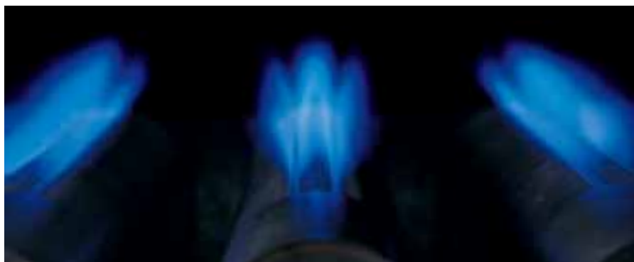
Rampes gaz, brûleur atmosphérique
